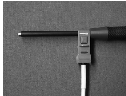
Abb. 5. Konnektion des elektromagnetischen «Trackers» an ein Wasserstrahl-dissektionsinstrument [8].
